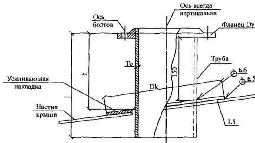
Рис.3.14. Патрубки на крыше
