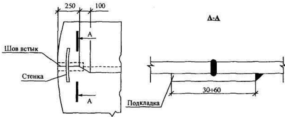
Рис.3.3. Соединения полотнищ днища
