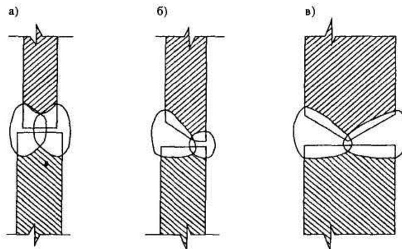
**Рис.3.2. Горизонтальные стыковые соединения стенки:**
