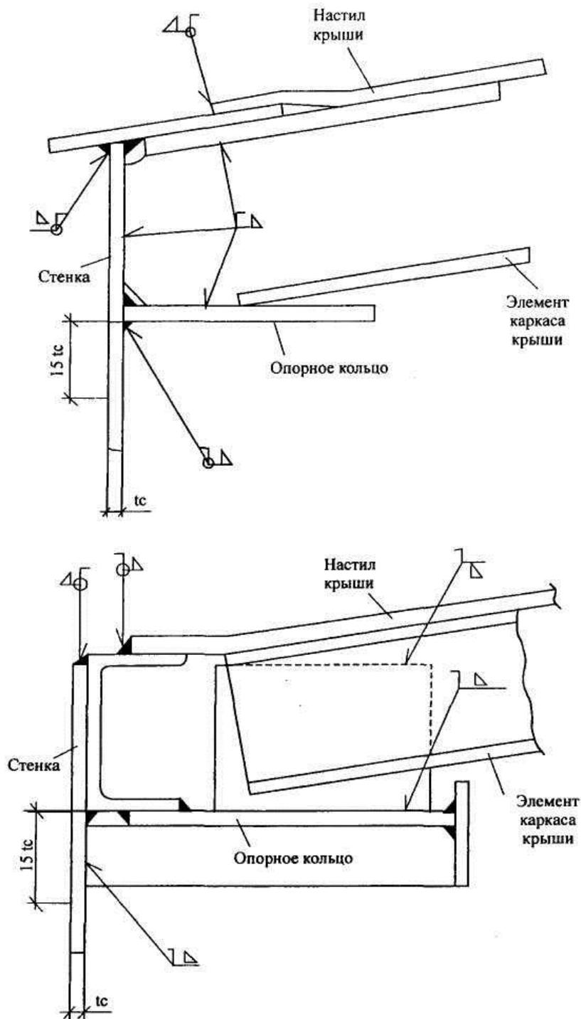
Рис.3.8. Соединение сферической крыши со стенкой
