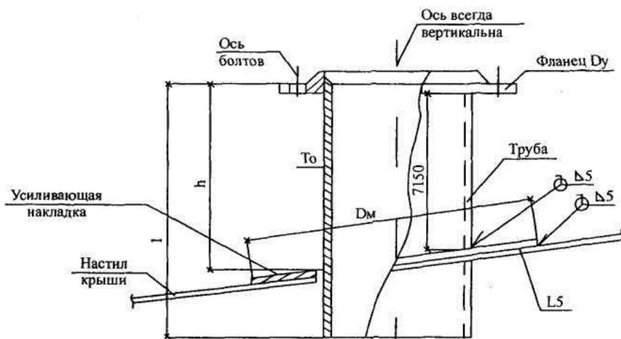
**Рис.3.16. Анкерное крепление стенки**
