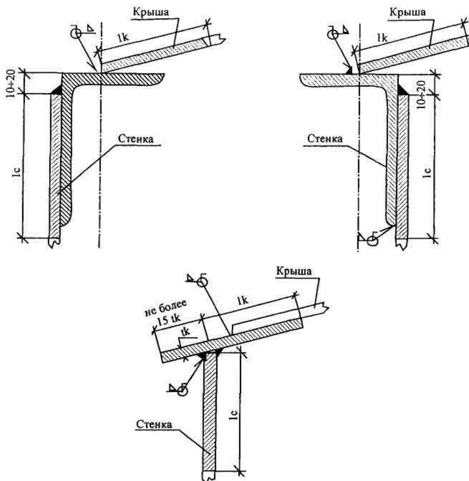
Рис.3.7. Соединения конической крыши со стенкой
