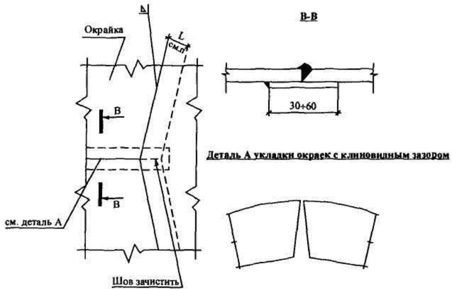
Рис.3.5. Соединение центральной части с окрайками днища
