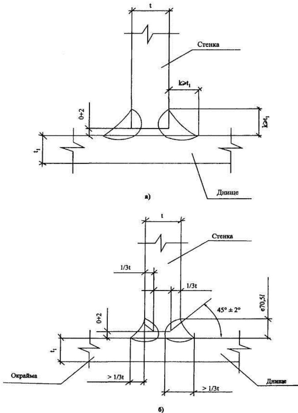
Рис.3.6. Соединение днища со стенкой
