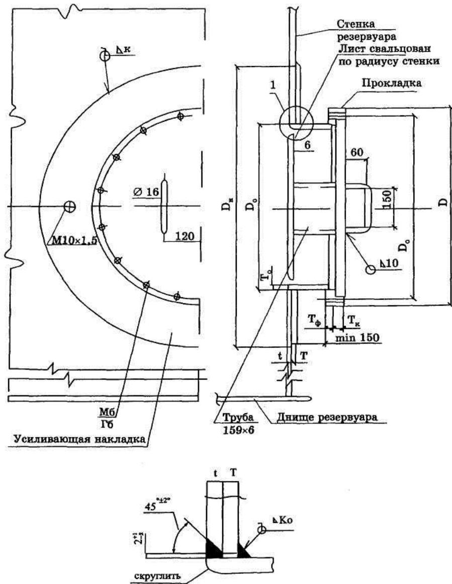
Рис.3.13. Люк-лаз круглый в III поясе стенки (резервуар с понтоном)
